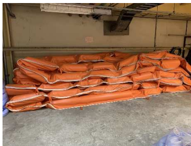
Boom สำหรับป้องกันการแพร่กระจายของน้ำมันบริเวณผิวน้ำ
